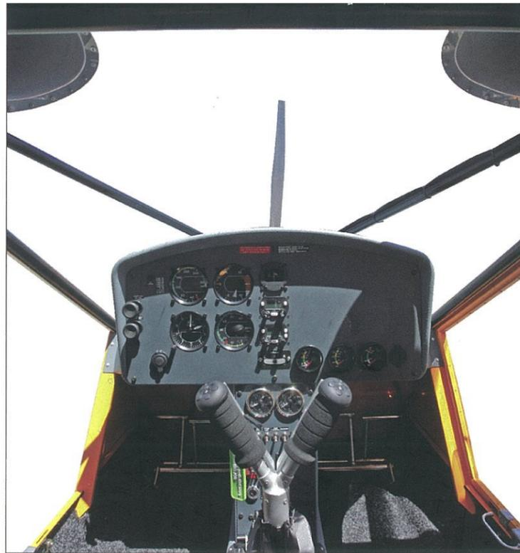
Steuerhorn oder Steuerknüppel, der Käufer hat die Wahl. Die Testmaschine ist mit einem Y-Knüppel auf der Mittelkonsole ausgestattet, was den Zugang an Bord erleichtert. Die Instrumente stammen von Kanardia.
